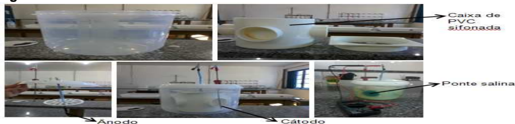
Figura 2 - Sistema de célula combustível microbiana.
